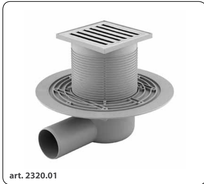
Siphon d'évacuation, complètement inspecté, Grille 105x105 mm, épaisseur 5 mm, mod. "LINEA". Sortie latéral Ø 50mm. Hauteur 70mm.
