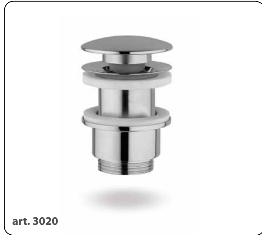
Vidage 1"1/4, STP, bouchon en laiton Ø72mm, système de commande toujours ouvert Pop-up waste 1"1/4, without overflow for washbasin, brass plug Ø72mm, "always open" control system
