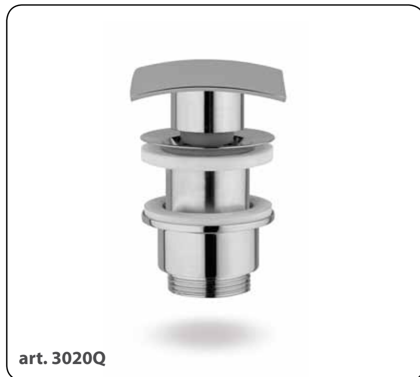
Vidage 1"1/4, STP, bouchon carré en laiton 70mm, système de commande toujours ouvert Pop-up waste 1"1/4, without overflow for washbasin, brass square plug 70mm, "always open" control system
