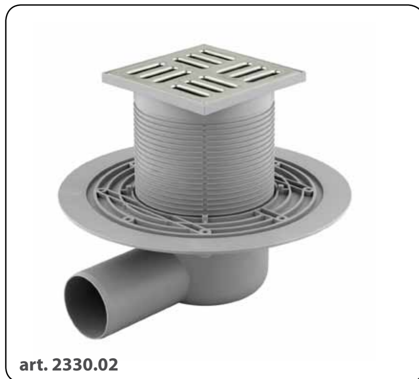
Siphon d'évacuation, complètement inspecté, Grille en ACIER INOX 105x105 mm, épaisseur 5 mm, mod. "GRAFFITI" Sortie latéral Ø 50mm.
