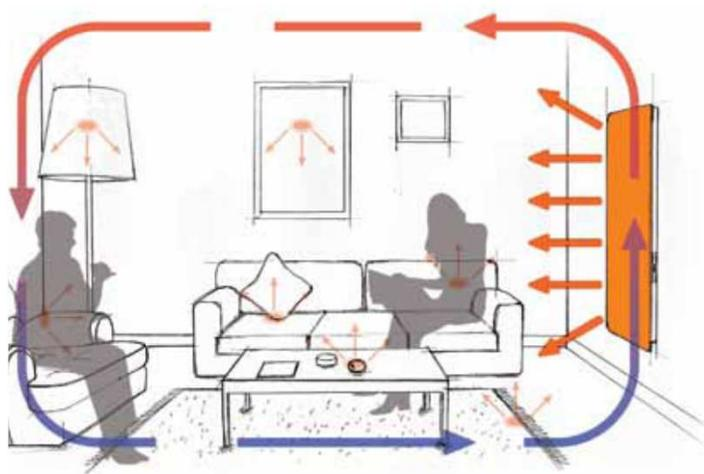
**La puissance thermique de nos radiateurs est supérieure à celle d'un radiateur traditionnel, grâce à la double action de la convection et de la radiation, pour un double confort.**
